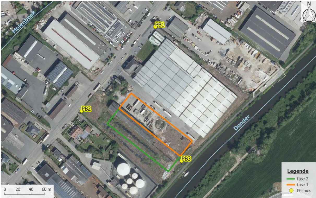
Figuur 4: Inplanting bouwput en peilbuizen.
