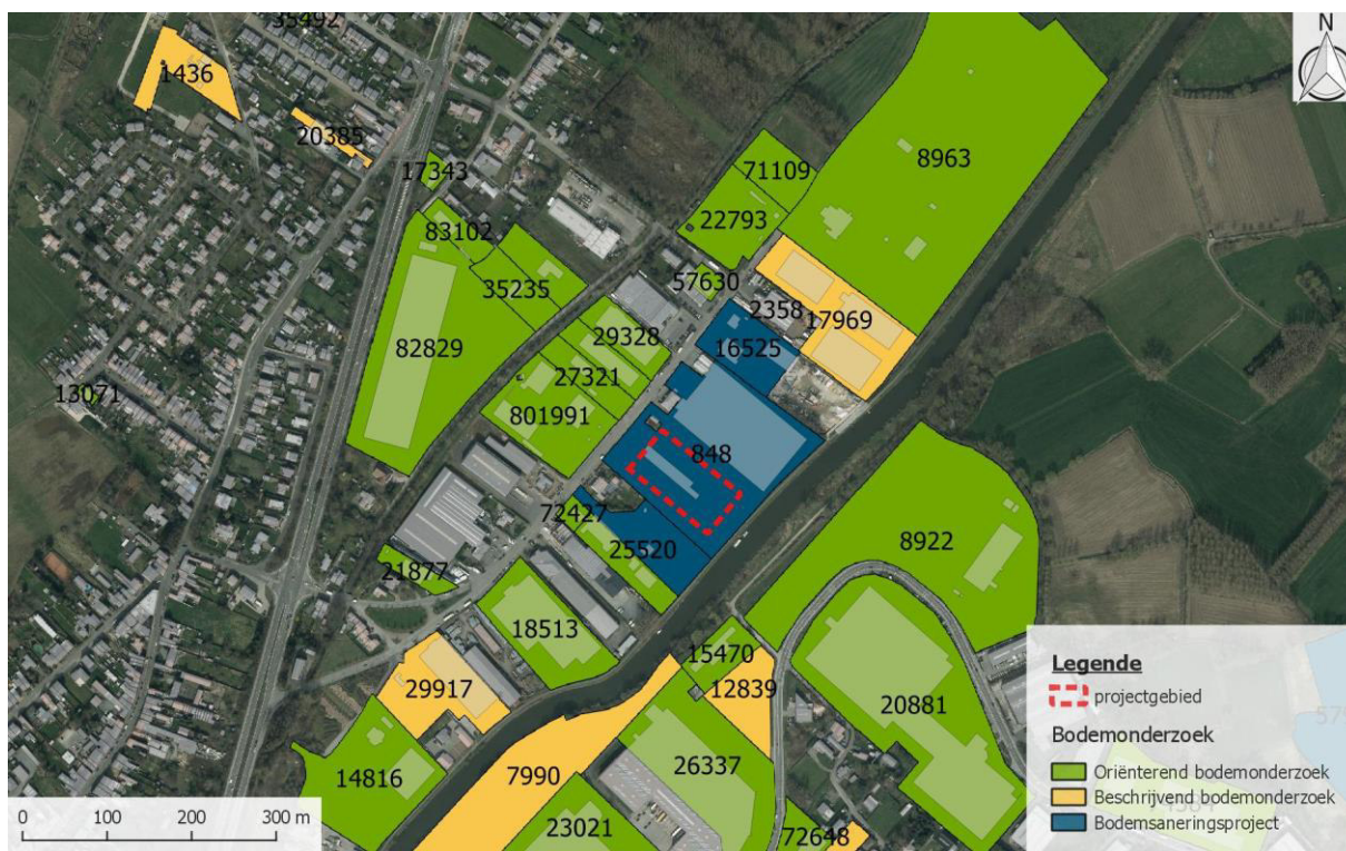
Figuur 6: Bodemonderzoeken in de omgeving van de bouwput.
